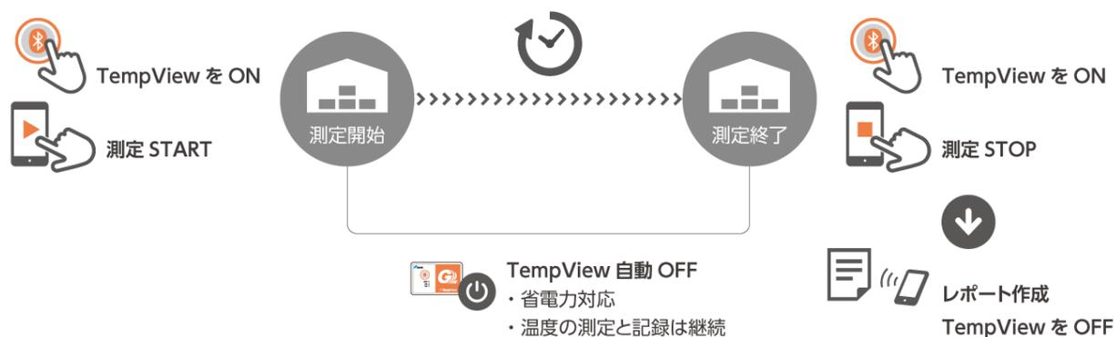
保存モードは長期間の測定を目的とした動作モードで、保管庫や倉庫での測定に使用されます。1～60分の間で設定した保存時間ごとに記録を行うことができ、比較的溫度変化が緩やかな環境での測定に適しています。測定を開始した後は、溫度ロガー本体のBluetooth通信を自動で切断し、省電力での測定を行います。
