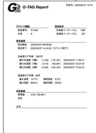
(左側上下) 振動ロガー「G-TAG TrecView」をパレットに設置し、振動データを記録。(右側) TrecViewで作成された測定レポート
